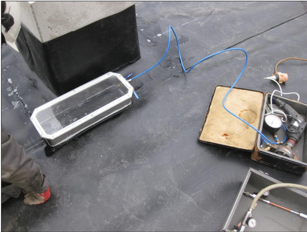
Kuva 4.4. Extrusiohitsaus, sauman koeponnistus vakuumikuppikokeella.
