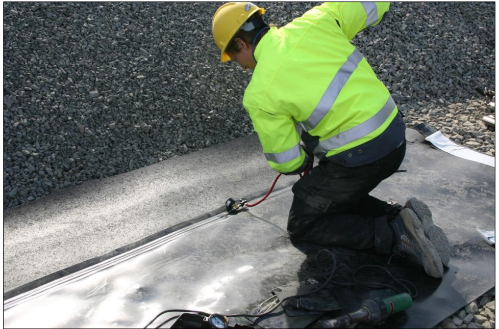
Kuva 4.3. Kuumakiilahitsatun koesauman koeponnistus.
